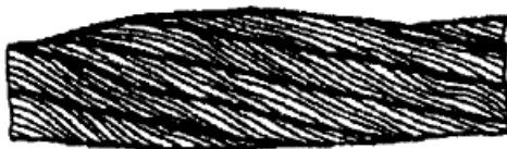
Рисунок 13. Местное увеличение диаметра каната.
