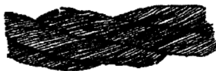
Рисунок 1. Обрывы и смещения проволок каната крестовой свивки.
