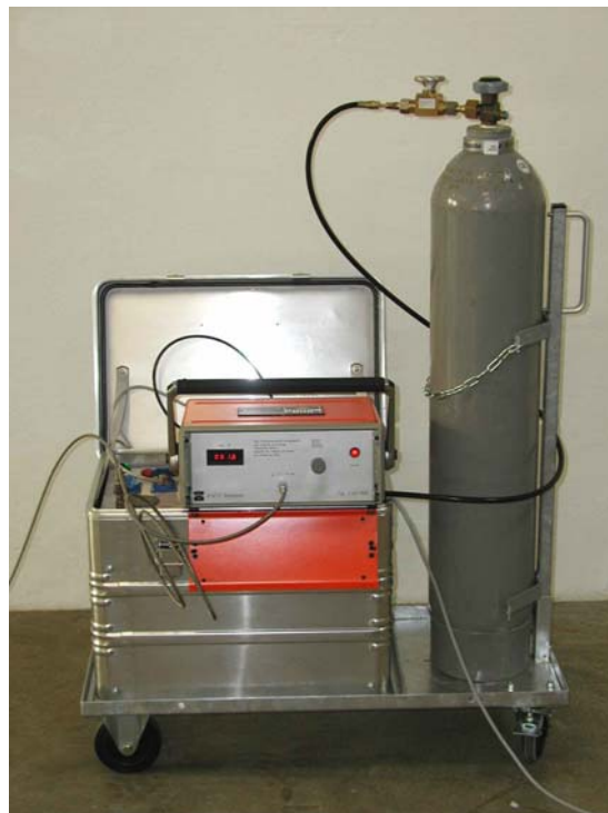
Рис. B151R01, тележка и баллон для элегаза являются принадлежностями, измерительный прибор не входит в объем поставки.
