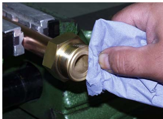
Перед сборкой очистить шпунт и канавку
