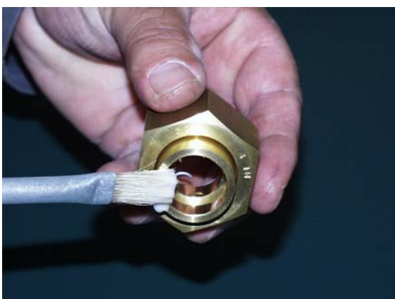
Наложить флюс на части, которые будут подвергаться пайке
