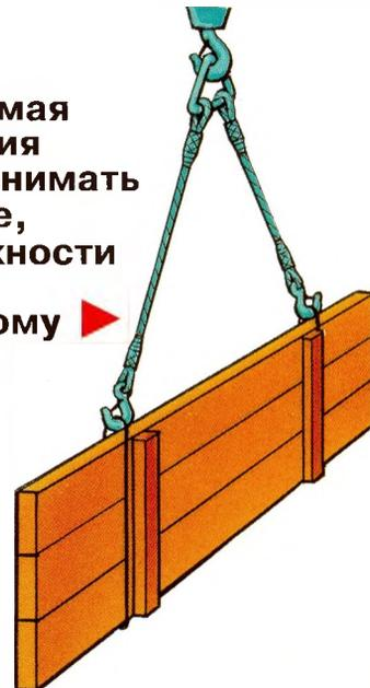
**КЛЕЩЕВЫЕ ЗАХВАТЫ** служат для перегрузки и транспортировки штучных грузов
