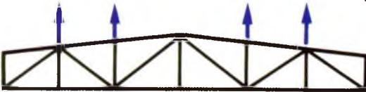
Фермы пролетом до 18 м стропуют в 2-х точках, а свыше 18 м - в четырех
