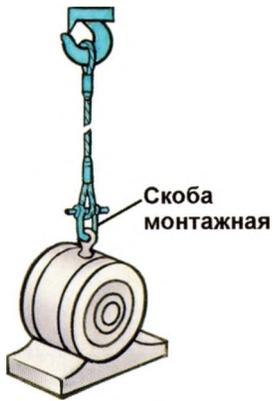
**СТРОПОВКА ЭЛЕКТРОДВИГАТЕЛЯ ДВУХПЕТЛЕВЫМ СТРОПОМ**
