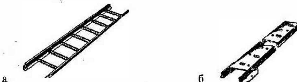
Рис. 2.41. Лотки: а — сварной, б — перфорированный
