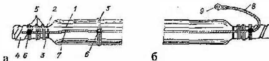
Рис. 3.1. Заземление свинцовой соединительной муфты:
